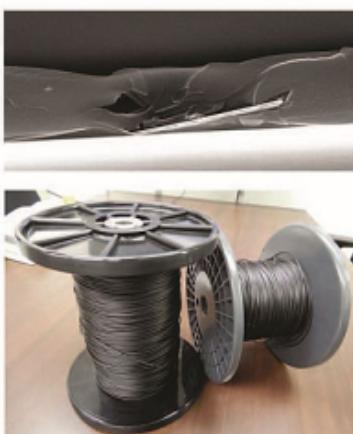
DCB試験後のCNF添加CFRPの電鏡写真(上)。CNFが炭素繊維の間にまで入り込んでいたことがわかる。CNFを添加した3Dプリンター用フィラメント
